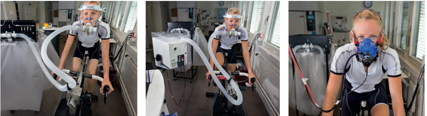
**Abbildung 2–3.** Verschiedene spirometrische Messsysteme. Von links: Douglas Bags, Mischkammer, Breath-by-breath.
